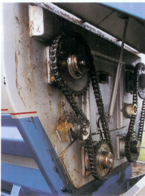
De bovenste vijzels worden aan de achterzijde van de wagen via tandwielen aangedreven. De grote achterklep wordt hydraulisch geopend met een handpompje.
